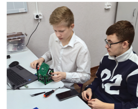
Обучающиеся центра «ИТК» ЦВР «Галактика» (г. Новосибирск) собирают учебный конструктор IntroSat. Такие же наноспутники запускают на аэростатах в рамках конкурса «Дежурный по планете»
